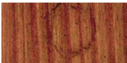
Superficie trattata con il balsamo protettivo: intatta
