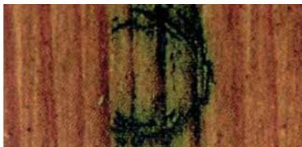
Superficie non trattata con il balsamo protettivo: comparsa di funghi dell'azzurramento
